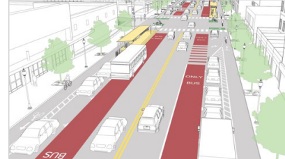
Carril de Tránsito Exclusivo
